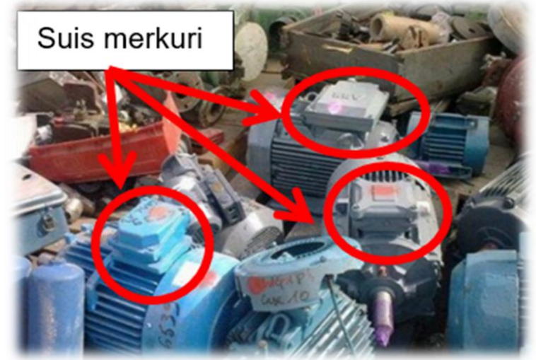
Sekerap motor elektrik yang mengandungi bahan berbahaya seperti suis merkuri - SW 422
